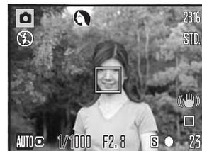
Appuyer à mi-course sur le déclencheur. Le système AF localise le sujet et la sélection automatique de programme détermine celui qui est le mieux adapté à la scène. Si aucun indicateur ne s'affiche, cela signifie que c'est le programme général qui a été sélectionné. Appuyer à fond sur le déclencheur pour prendre la photo. Maintenir l'appareil bien stable lorsque le programme Coucher de soleil est sélectionné, car l'exposition peut être longue.
