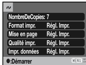
Le nombre d'impressions est affiché ainsi que les paramètres d'impression sélectionnés avec le menu. Voir la section sur la navigation du menu pour davantage d'informations (p. 114). Appuyer sur la touche centrale du contrôleur pour lancer l'impression, ou appuyer sur la touche Menu pour revenir à l'écran PictBridge. Il est possible d'imprimer un maximum de 50 images.
