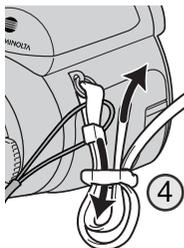
Engager l'extrémité de la courroie dans le cavalier comme indiqué ci-contre (4). Renouveler la procédure pour l'autre extrémité de la courroie.
