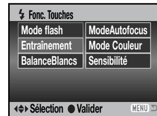
Une pression sur la touche de mode flash permet de changer la fonction réglée dans le menu. Appuyer sur la touche centrale du contrôleur ou appuyer à mi-course sur le déclencheur pour appliquer le réglage.
