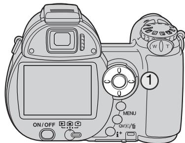
Après avoir mis en place les piles et une carte mémoire, il faut procéder au réglage de l'horloge et du calendrier de l'appareil. Lorsque les images sont enregistrées, la date et l'heure de leur enregistrement leur sont associées.
