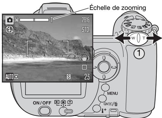
Le zooming est commandé par le contrôleur (1). Une pression sur le levier vers la droite (T) commande le zooming vers les focales téléobjectif. Une pression vers la gauche (W) commande le zooming vers les focales grand-angle.
