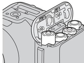
Mettre les piles en place comme indiqué sur le schéma figurant sur le dessous de la porte du compartiment. S'assurer que les polarités sont correctement orientées.
