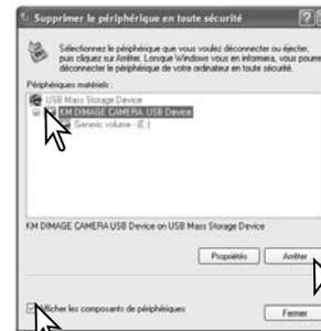
Les périphériques connectés au système sont affichés. Cliquer sur la case des composants du dispositif. Sélectionner le périphérique concerné en cliquant dessus puis cliquer sur "Arrêter."
