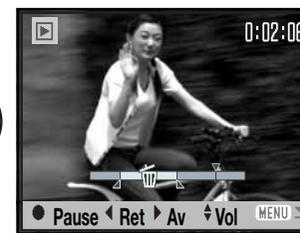
Appuyer sur la touche centrale du contrôleur pour visualiser le montage. La flèche au-dessus de l'échelle indique l'emplacement de la vue dans la vidéo.
