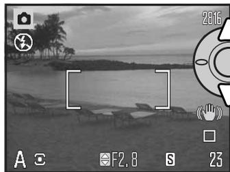
Agir sur les touches haut/bas du contrôleur (1) pour régler l'ouverture. La valeur d'ouverture peut être modifiée par tiers de valeur. Appuyer à mi-course sur le déclencheur pour activer le système d'exposition : la vitesse correspondante s'affiche alors à l'écran.
