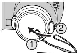
Engager l'une des petites boucles du cordon de capuchon d'objectif dans l'œillet du capuchon (1). Passer l'autre boucle dans la première et serrer l'ensemble (2).
