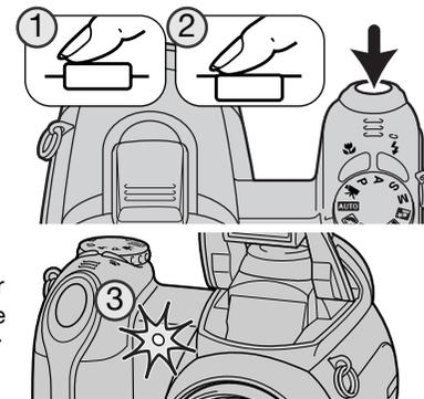
Comme l'exposition et la mise au point sont déterminées à la pression à mi-course sur le déclencheur, ne pas se placer devant l'objectif durant cette opération. Toujours vérifier que la mise au point est bien effectuée en contrôlant l'indicateur avant de lancer le décompte (p. 25).
