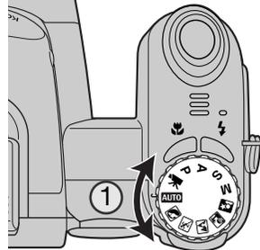
Placer le sélecteur de mode en position mode Enregistrement auto (1) : toutes les fonctions de l'appareil sont alors automatiques. La mise au point autofocus, l'exposition et les systèmes d'acquisition de l'image travaillent de concert afin de produire les meilleurs résultats possibles.
