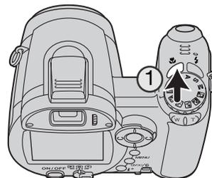
Deux modes Macro sont disponibles : Super Macro et Macro Standard. Le mode Super Macro permet une mise au point à 1 cm du sujet (distance calculée à partir de l'objectif). Dès que ce mode est sélectionné, l'objectif se règle automatiquement sur une focale particulière qui ne peut être modifiée. Le mode Macro Standard permet d'utiliser le zoom normalement. La distance de mise au point mini change avec la focale, voir ci-dessous.
