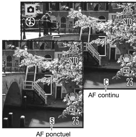
En mode programmes-résultats numériques (DSP), le mode mise au point automatique varie en fonction du programme utilisé. Le mode sport utilise l'AF en continu et les autres programmes, le mode vue par vue. Ces réglages de mode AF sont fixes pour ces programmes-résultats.
