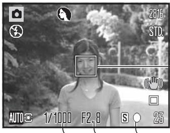
Placer le sujet dans la zone AF, appuyer à mi-course sur le déclencheur et le maintenir dans cette position.
