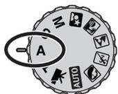
Le photographe choisit l'ouverture et l'appareil règle automatiquement la vitesse correspondante pour la bonne exposition. En mode priorité à l'ouverture, la valeur d'ouverture s'affiche à l'écran en bleu et une icône en forme de double-flèche apparaît à côté. Le mode flash peut être réglé sur flash forcé, flash forcé avec réduction des yeux rouges ou synchro lente avec réduction des yeux rouges (p. 26).
