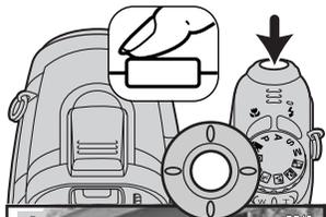
Appuyer à mi-course sur le déclencheur ou appuyer au centre du contrôleur pour sélectionner la zone souhaitée. Les quatre autres zones disparaissent. Le contrôleur peut être utilisé pour d'autres opérations uniquement lorsque la zone de mise au point a été sélectionnée.
