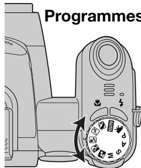
Les programmes-résultats optimisent l'exposition, la balance des blancs et le traitement de l'image pour des sujets et des conditions de prises de vues spécifiques. Tourner simplement la molette pour sélectionner le sujet approprié. Le programme-résultat actif est affiché dans le coin inférieur gauche de l'écran.
