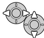
Pour les vidéos, les touches droite/gauche permettent d'avancer, de revenir ou de redémarrer le clip. Les touches haut/bas permettent de régler le volume.
