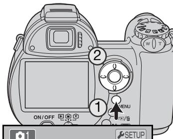
La langue d'affichage des menus peut être réglée en fonction du souhait de l'utilisateur. Appuyer sur la touche Menu (1) pour ouvrir le menu ; l'apparence du menu dépend de la position des commandes de l'appareil.
