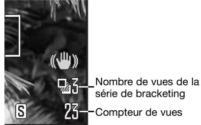
Le nombre de vues restantes de la série est affiché sur l'écran près de l'indicateur de bracketing. Si la mémoire est pleine ou si le déclencheur est relâché avant que la série ne soit terminée, l'appareil est réinitialisé et la série doit être entièrement recommencée. Si le témoin rouge de piles faibles apparaît, le mode bracketing est annulé. Le flash ne peut pas être utilisé en mode bracketing.
