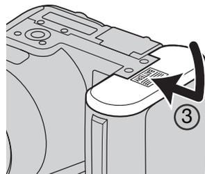
Refermer la porte du compartiment pile et la faire coulisser vers le boîtier (3) pour encliqueter le dispositif de sécurité.
