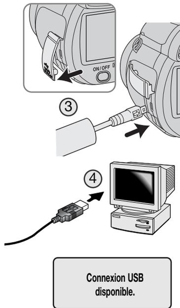
1. Démarrer le micro-ordinateur. Le micro-ordinateur doit être mis en marche avant la connexion.
