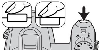
Cadrer comme indiqué dans le chapitre sur l'enregistrement de base (p. 22). Appuyer à mi-course sur le déclencheur pour effectuer la mise au point et l'exposition. Appuyer à fond sur le déclencheur pour lancer l'enregistrement.
