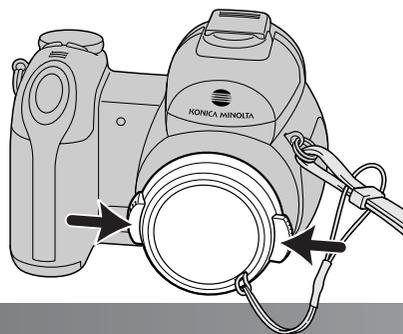
Avec le pouce et l'index, pincer les clips du capuchon d'objectif pour le fixer ou le retirer de son emplacement sur l'objectif. Lorsque l'appareil n'est pas utilisé, toujours remettre le capuchon en place.
