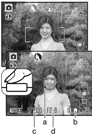
Placer le sujet à l'endroit souhaité à l'intérieur de la plage AF. Vérifier que le sujet est bien dans la gamme de distances de mise au point de l'objectif (p. 24). Pour des sujets très proches, utiliser la fonction Macro (p. 35).
