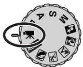
Cet appareil peut enregistrer des vidéos numériques avec accompagnement sonore. La durée totale d'enregistrement varie avec la cadence d'acquisition des vues, voir page 68. Le zoom optique et le zoom numérique, la correction d'exposition et les modes macro peuvent être utilisés. D'autres modifications peuvent être effectuées dans le menu Enregistrement vidéo (p. 44).
