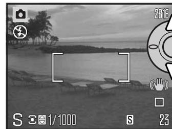
Agir sur les touches haut/bas du contrôleur (1) pour régler la vitesse. Appuyer à mi-course sur le déclencheur pour activer le système d'exposition : l'ouverture correspondante s'affiche alors à l'écran.
