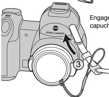
Engager la petite boucle de la courroie de cou dans la boucle du cordon de capuchon d'objectif, puis dans l'œillet de l'appareil (3).
