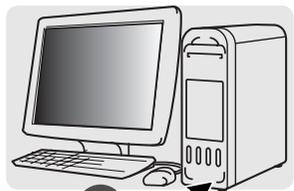
4. Raccorder l'autre extrémité du câble USB au port USB du micro-ordinateur. Vérifier que le câble est bien raccordé. L'appareil doit être raccordé directement au port USB du micro-ordinateur. Le raccordement à un hub peut empêcher le bon fonctionnement de l'appareil.
