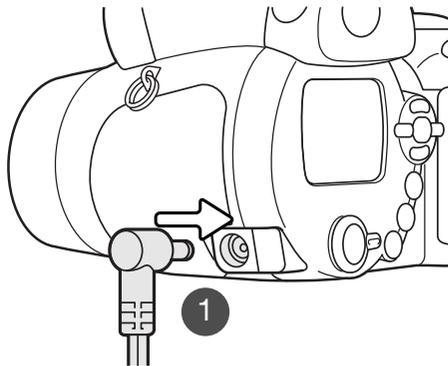
L'adaptateur secteur AC-11 permet d'alimenter l'appareil à partir d'une prise de courant secteur. L'utilisation de cet adaptateur est recommandée lorsque l'appareil est connecté à un micro-ordinateur ou lors d'une utilisation intensive.
