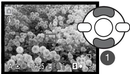
Utiliser les touches haut/bas du contrôleur (1) pour régler l'ouverture. Trois valeurs d'ouverture sont disponibles. Appuyer à mi-course sur le déclencheur pour activer le système d'exposition : la vitesse correspondante s'affiche alors à l'écran.
