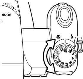
Les programmes-résultats optimisent l'exposition, la balance des blancs et le traitement de l'image pour des sujets et des conditions de prises de vues spécifiques. Tourner simplement la molette pour sélectionner le sujet approprié. Le programme-résultat actif est affiché dans le coin inférieur gauche de l'écran.
