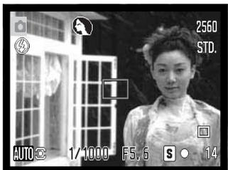
Sans relâcher le déclencheur, recomposer la scène pour décentrer le sujet principal. Appuyer à fond sur le déclencheur pour prendre la photo.
