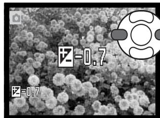
Pour appliquer une correction d'exposition, appuyer sur la touche gauche ou droite du contrôleur. L'écran de correction d'exposition apparaît.
