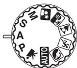
Le photographe choisit l'ouverture et l'appareil règle automatiquement la vitesse correspondante pour la bonne exposition. En mode priorité à l'ouverture, la valeur d'ouverture s'affiche à l'écran en bleu et un icône en forme de double-flèche apparaît à côté. Le mode flash peut être réglé sur flash forcé, flash forcé avec réduction d'yeux rouges ou synchro lente avec réduction des yeux rouges (p. 26).
