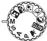
Le mode Manuel permet la sélection indépendante des deux paramètres vitesse et ouverture. Ce mode débraye le système d'exposition automatique et laisse au photographe le contrôle total du réglage d'exposition.
