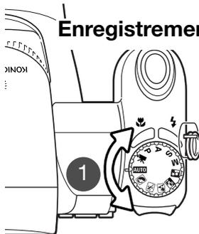
Placer le sélecteur de mode en position mode Enregistrement Auto (1) : toutes les fonctions de l'appareil sont alors automatiques. La mise au point autofocus, l'exposition et les systèmes d'acquisition de l'image travaillent de concert afin de produire les meilleurs résultats possibles.
