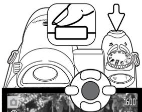
Appuyer à mi-course sur le déclencheur ou appuyer au centre du contrôleur pour sélectionner la zone souhaitée. Les 2 autres zones disparaissent. Le contrôleur peut être utilisé pour d'autres opérations uniquement lorsque la zone de mise au point a été sélectionnée.
