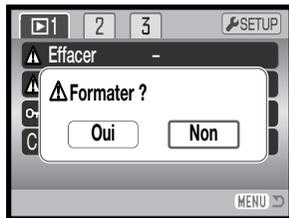
Une carte mémoire utilisée dans un autre appareil photo peut avoir besoin d'être formatée avant d'être utilisée. Si le message "impossible d'utiliser la carte" apparaît, la carte doit être reformatée dans l'appareil. Si le message "Erreur carte" apparaît, appuyer sur la touche centrale du contrôleur pour fermer la fenêtre. Consulter le site Internet de Konica Minolta pour davantage d'informations sur les compatibilités :
