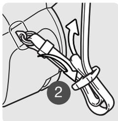
Engager l'extrémité de la courroie dans le cavalier comme indiqué ci-contre (2). Renouveler la procédure pour l'autre extrémité de la courroie.
