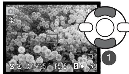
Agir sur les touches haut/bas du contrôleur (1) pour régler la vitesse. Appuyer à mi-course sur le déclencheur pour activer le système d'exposition : l'ouverture correspondante s'affiche alors à l'écran.
