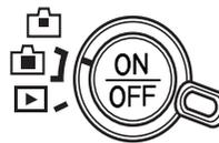
**Mode Enregistrement (affichage viseur)** : l'appareil peut enregistrer des images et l'affichage de l'écran est commuté dans le viseur. Ce viseur comporte un dispositif de réglage dioptrique intégré. Tout en regardant dans le viseur, tourner la molette de réglage dioptrique jusqu'à ce que l'image apparaisse bien nette.
