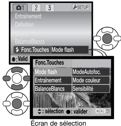
Une pression sur la touche de mode flash permet de changer la fonction réglée dans le menu. Appuyer sur la touche centrale du contrôleur ou appuyer à mi-course sur le déclencheur pour appliquer le réglage.
