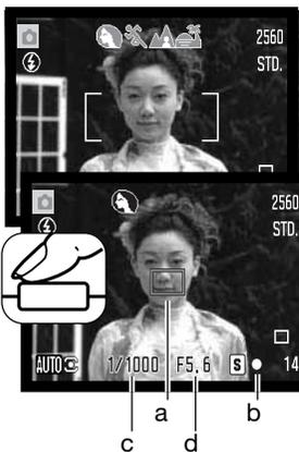
Placer le sujet à l'endroit souhaité à l'intérieur de la plage AF. Vérifier que le sujet est bien dans la gamme de distances de mise au point de l'objectif (p. 24). Pour des sujets très proches, utiliser la fonction Macro (p. 35).
