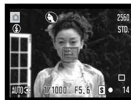
Appuyer à mi-course sur le déclencheur. Le système AF localise le sujet et la sélection automatique de programme détermine celui qui est le mieux adapté à la scène. Si aucun indicateur ne s'affiche, cela signifie que c'est le programme général qui a été sélectionné. Appuyer à fond sur le déclencheur pour prendre la photo. Maintenir l'appareil bien stable lorsque le programme Coucher de soleil est sélectionné car l'exposition peut être longue.
