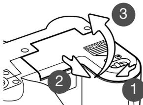
Pour ouvrir la porte du logement piles, pousser le verrou vers la position ouverte (1). Faire coulisser la porte vers l'avant de l'appareil (2) pour la déverrouiller. Soulever la porte pour l'ouvrir (3).
