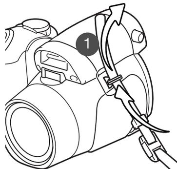
Passer l'extrémité de la courroie dans l'œillet de courroie (1).
