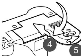
Fermer la porte du logement piles et la faire coulisser vers l'arrière de l'appareil (4) de manière à la verrouiller. Pousser le verrou vers la position fermée (5).
