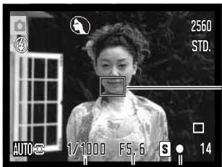
Placer le sujet dans la zone AF, appuyer à mi-course sur le déclencheur et le maintenir dans cette position.
