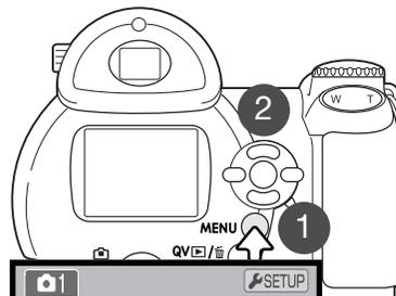
La langue d'affichage des menus peut être réglée en fonction du souhait de l'utilisateur. Appuyer sur la touche Menu (1) pour ouvrir le menu. L'apparence du menu dépend de la position des commandes de l'appareil.
