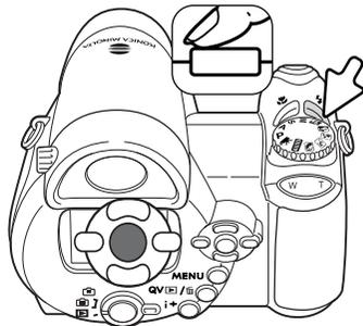
Lors de la sélection du mode bracketing ou de la balance des blancs pré-réglée, un écran de sélection apparaît. Utiliser les touches gauche/droite du contrôleur pour afficher l'incrément de bracketing ou la balance des blancs pré-réglée et appuyer au centre du contrôleur pour leur sélection.
