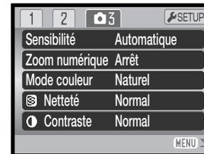
Le réglage automatique règle automatiquement la sensibilité entre 50 et 160 ISO en fonction des conditions de lumière. Lorsqu'un réglage autre que Automatique est sélectionné, « ISO » et la valeur sélectionnée sont affichées sur l'écran ACL.
