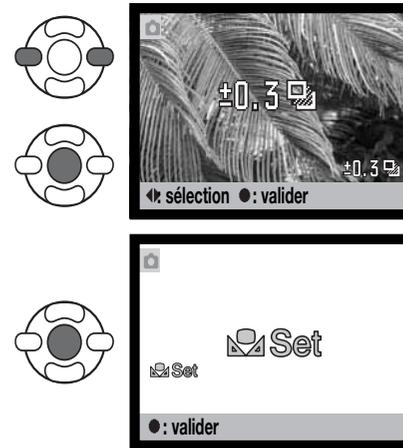
En cas de sélection de la balance des blancs personnalisée, un écran de calibration est affiché. Cadrer entièrement sur un objet blanc et appuyer sur la touche centrale du contrôleur pour calibrer l'appareil.
