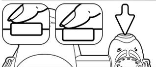
Cadrer comme indiqué dans le chapitre de base sur l'enregistrement (p. 22). Appuyer à mi-course sur le déclencheur pour effectuer la mise au point et l'exposition. Appuyer à fond sur le déclencheur pour lancer l'enregistrement.
