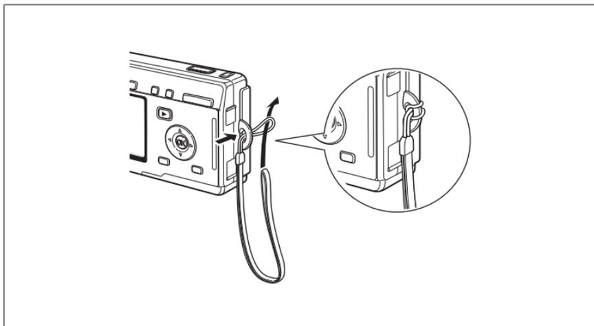
Glissez l'extrémité étroite de la courroie dans l'attache de la courroie et passez l'autre extrémité dans la boucle.
