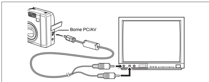
Le câble AV vous permet de visualiser vos images sur un écran de téléviseur ou tout autre équipement à l'aide d'un connecteur IN vidéo. Veillez à ce que le téléviseur et l'appareil soient tous les deux hors tension avant d'effectuer le branchement.
