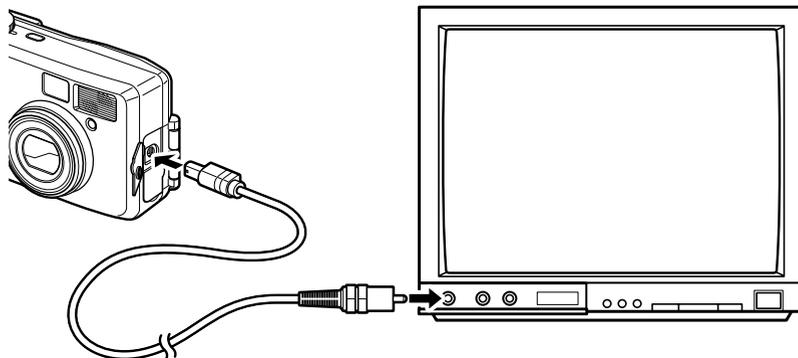
En utilisant le câble de liaison vidéo, vous pouvez vous servir d'un téléviseur ou d'un autre équipement vidéo disposant d'un connecteur d'entrée pour voir vos photos ou servir de moniteur grand format pendant la prise de vue. Veillez à ce que le téléviseur et l'appareil soient tous les deux hors tension avant d'effectuer le branchement.
