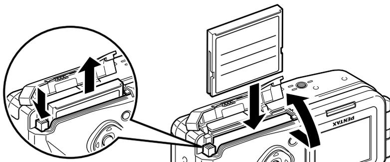
Les images capturées sont enregistrées sur la carte CompactFlash (CF). Veillez à ce que l'appareil soit hors tension avant d'installer ou d'extraire la carte ou d'extraire CF (en option).
