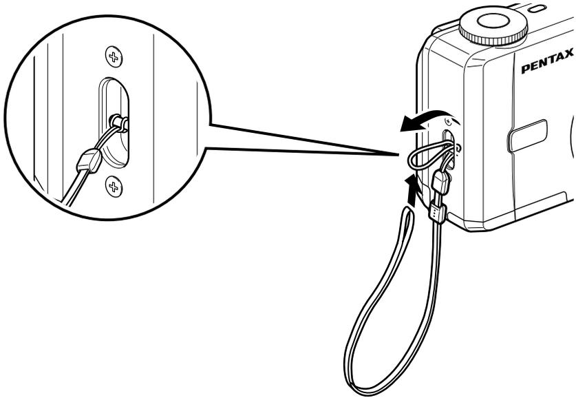
Glissez l'extrémité étroite de la courroie dans l'attache de la courroie et passez l'autre extrémité dans la boucle.
