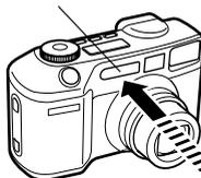
Placez les deux appareils à proximité l'un de l'autre. Placez les deux appareils à proximité l'un de l'autre et de manière à ce que leurs systèmes de transmission par infrarouge respectifs soient face à face.
