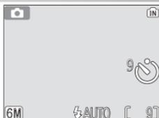
Le témoin du retardateur sur le devant de l'appareil photo cessera de clignoter une seconde avant le déclenchement, s'allumant fixement la dernière seconde pour vous signaler que la photo va être prise.
