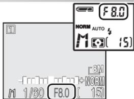
Sélectionnez l'autre paramètre (ouverture ou vitesse d'obturation). Répétez les étapes 2–3 jusqu'à l'obtention de l'exposition souhaitée.
