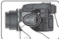
Au cours de la prise de vue, faites attention de ne pas appuyer sur les commandes situées sur le côté gauche de l'appareil photo.
